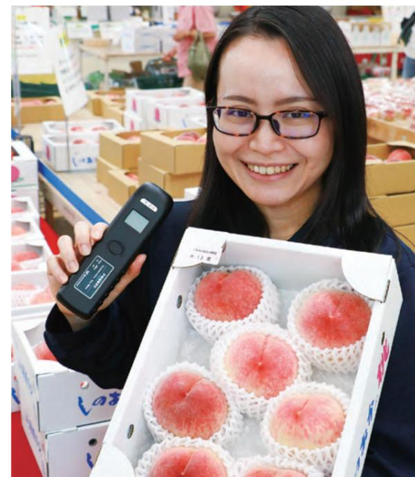
▲ 導入された非破壊糖度計と糖度表示された桃
